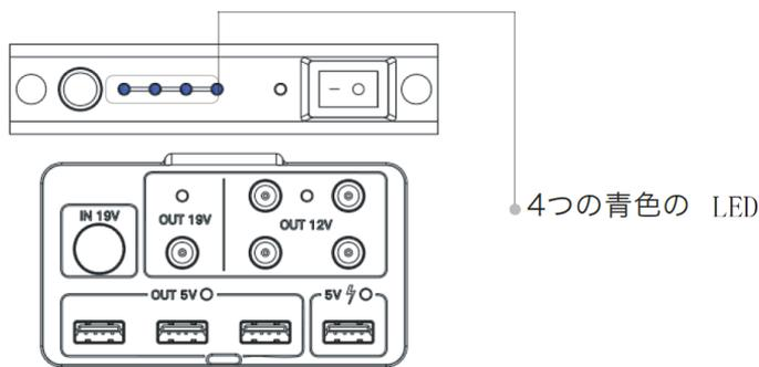
2. 動作状態 「dc出力スイッチ」(led1 25%、led2、led3、led4 100%)をクリックする
