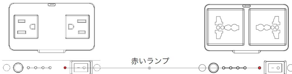
8.ac出力は、acキーの電源を入れた後、ac口出力を接続し、赤色のランプが点灯している図のように
