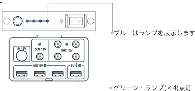
4.出力:「dc出力スイッチ」が本製品をオンした後、dcの口やusbの口出力を接続し、青色の電力表示ランプと緑色のdcの動作指示を接続する。明かりが常である
